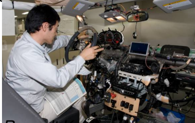
у Renault Koleos - необходимо выявить все возможные неисправности электрической
