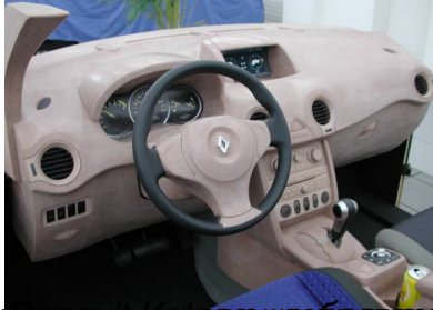
Renault Koleos - проектная модель передней панели, на этом этапе, передняя
