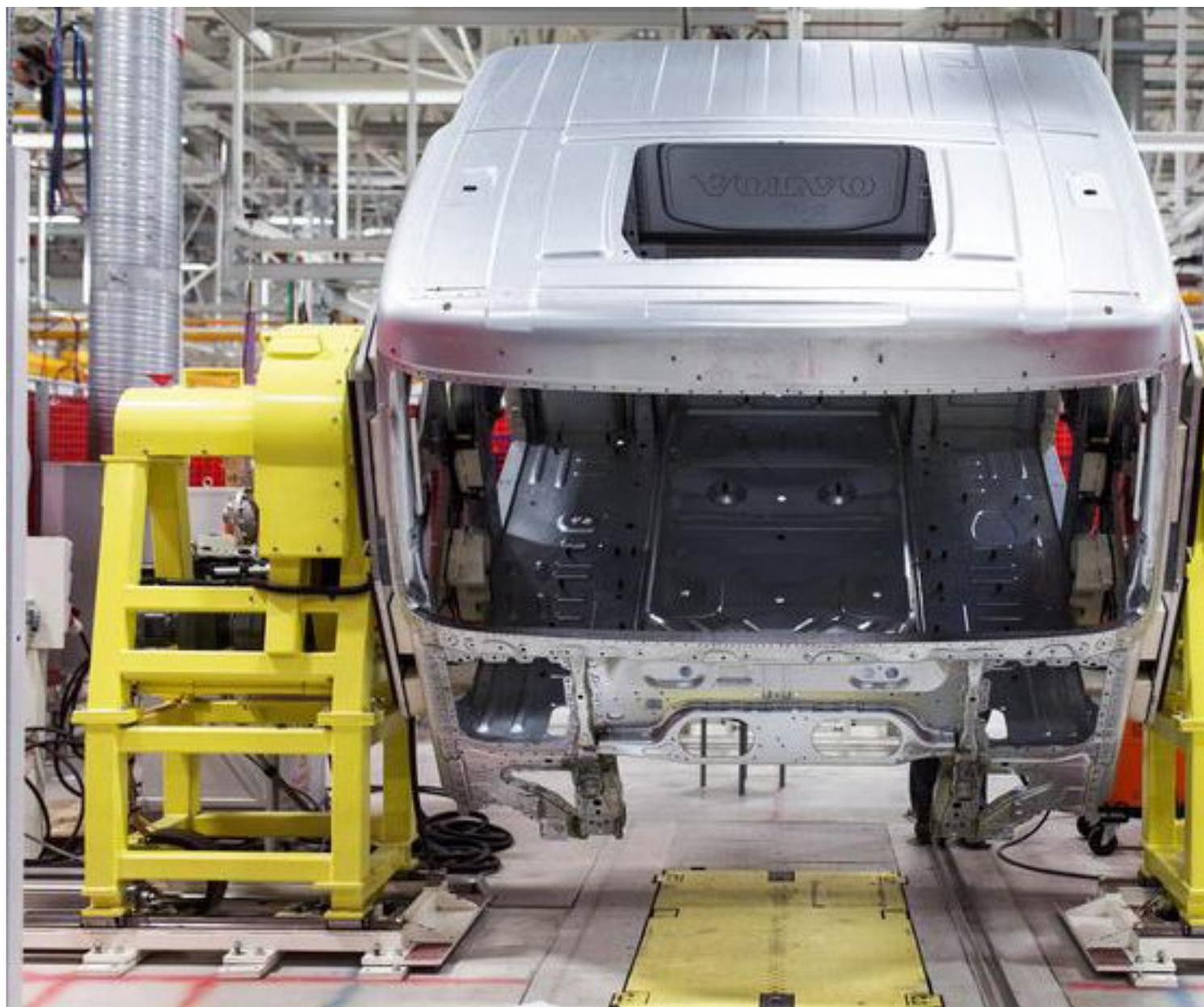
Завод кабин полностью соответствует корпоративным стандартам и требованиям качества принятых на предприятиях группы Volvo Trucks. Цикл производства разбит на четыре участка: сырьевой склад, сборка (сварка), покраска и склад готовой продукции. Это одна из унифицированных (самых простых) цепочек производства, она
